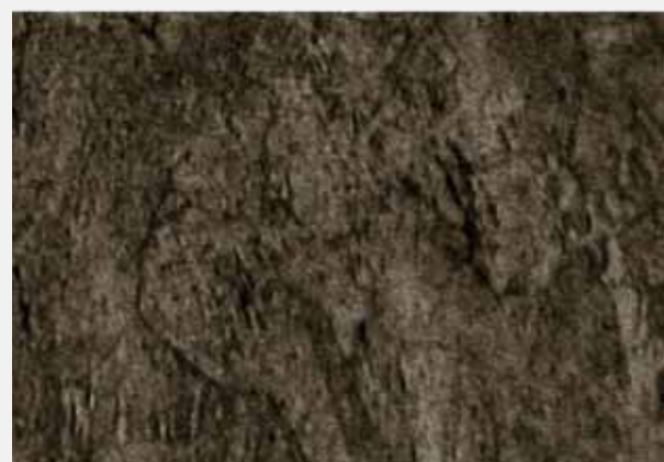
Estructura de grano fino de CuCrZr de Luvata
