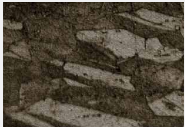
Estructura convencional de grano CuCrZr
